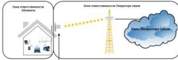
СХЕМА ВКЛЮЧЕНИЯ ПОЛЬЗОВАТЕЛЬСКОГО (ОКОНЕЧНОГО) ОБОРУДОВАНИЯ ПО ТЕХНОЛОГИИ xPON
